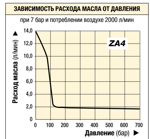
Насосы серии ZA4 с 10, 20 и 40-литровыми резервуарами
