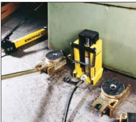
▼ Перевозка резервуара для химикатов: Первые несколько сантиметров подъема были достигнуты при помощи низкопрофильных цилиндров серии RCS, после чего груз был передвинут на тележки для перевозки.
