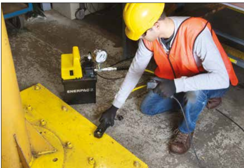
◀ Насос с погружным мотором PED-1101E обеспечивает быстрый и бесшумный привод гидравлического гайкореза при работах по техническому обслуживанию.
