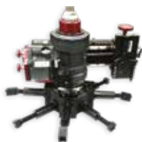
Станки для обработки уплотнительных поверхностей фланцев с креплением на внутренней поверхности
