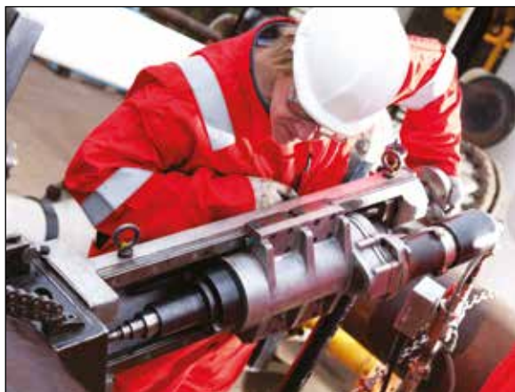
▼ Портативный сверлильный станок HT40.
