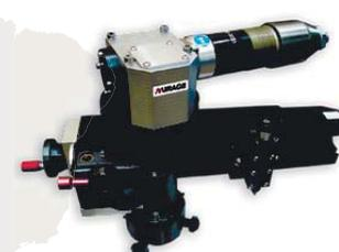
Зубчатый привод для создания непрерывной канавки, для нарезки на поверхности круговых канавок (по типу граммофонной пластинки) (стандарт ASME)
